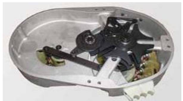
**Fig. 8. Mecanismo Roda de Genebra**
