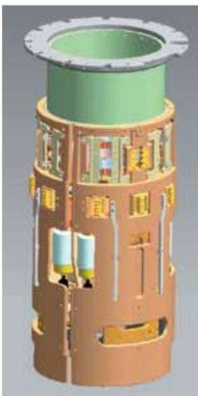
Fig. 7 Parte estraibile dell'interruttore di commutazione
