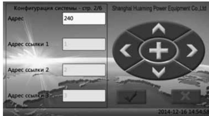
Адрес соединения (ссылки): необходимо соответствие с адресом дистанционного контроллера. По умолчанию заводской адрес модуля SHM-K является 1.
