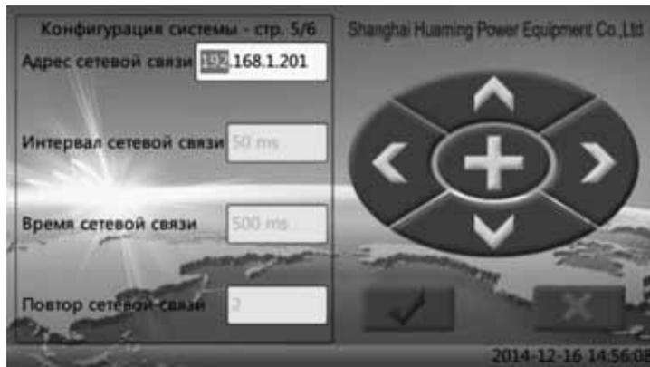
Когда установленный способ соединения является сетевой синхронизацией, здесь установить сетевой адрес другого дистанционного контроллера и соответствующие параметры связи. Когда способ соединения является «оптоволоконный», то параметры не имеют значения.
