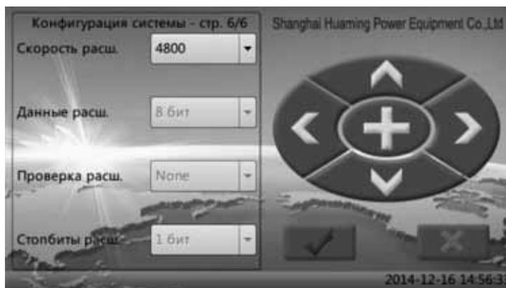
Когда включена функция локального расширения, можно установить параметры связи для протокола CDT. Если не включено локальное расширение, то параметры не действуют.
