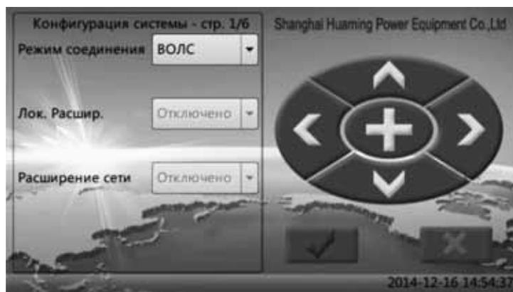
**Режим соединения:** установится способ получения данных от привода, по умолчанию оптоволоконный способ. Имеется 4 способа: оптоволоконный (ВОЛС), оптоволоконный 2, оптоволоконный 3, и синхронно сети.
