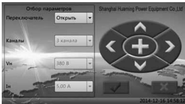
Когда система работает в режиме автоматического регулирования напряжения, в данном окошке устанавливаются соответствующие параметры. Данное окошко совместно с окошком установки переменного тока может обеспечить правильность данных.
