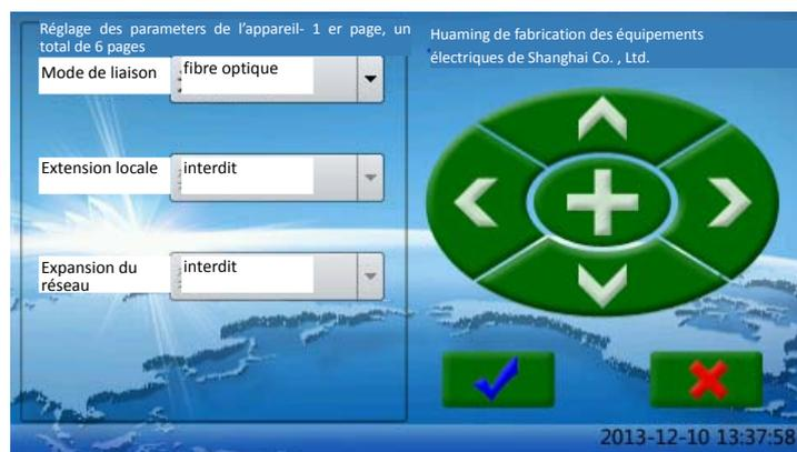
Mode de liaison : soit le mode à sélectionner l'appareil, et obtenir des données en temps réel de l'unité électrique, le mode de fibre optique par défaut. Un total de 4 modes à choisir : le mode de fibre optique 1, le mode de fibre optique 2, le mode de fibre optique 3, la synchronisation de réseau.
