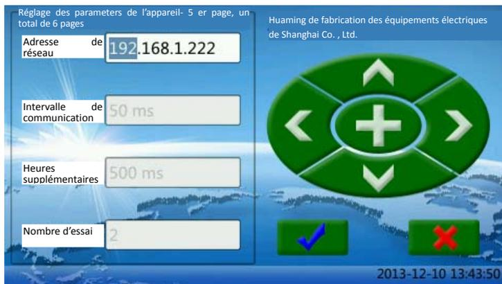
Lorsque le mode de liaison de l'appareil est la synchronisation de réseau, les paramètres de conformément à cet image, l'adresse de réseau du contrôleur à distance d'autre côté et les paramètres de communication seront réglés. Lorsque le mode de liaison de l'appareil est la fibre optique, il sera négatif.
