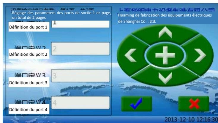
L'appareil a 7 ports de sortie de relais, offrant les points passifs pour les utilisateurs. Les ports peuvent être changés en fonction des besoins de l'utilisateur.
