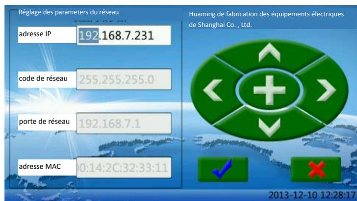
Le contrôleur à distance fonctionnant en mode parallèle ( la connexion parallèle automatique, la connexion parallèle manuelle, parallèle à la machine esclave ) ou dans le cas de la synchronisation de réseau, il a la nécessité de mettre en place l'adresse de réseau et les paramètres associés. L'adresse de réseau doit être routable.
