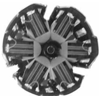
Fig. 10 Disposizione dei resistori di transizione
